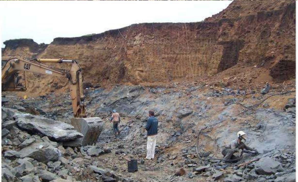
Figura 8.3-1 : Foto superior arranque con retro de basalto geódico blando en forma de frente. En el piso se observan "asomos" de basalto geódico duro. En la foto inferior ya se comenzó a trabajar en frente sobre roca dura con barrenos y explosivos. Esta zona posiblemente se explote más adelante en forma subterránea. En primer plano se ve a un obrero cortando una pequeña geoda con martillo neumático.
