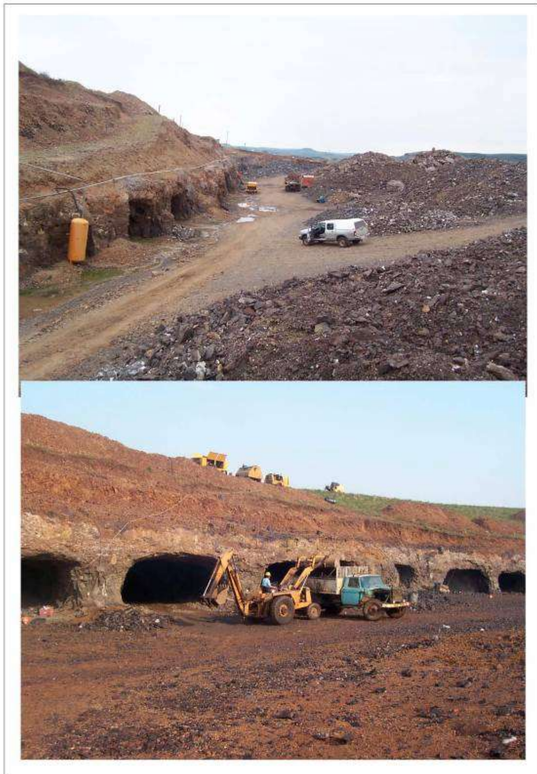
Figura 8.3-5 : Explotación por el método subterráneo, sobre basalto duro. Cada boca tiene una altura máxima de 3 m y presenta 1 o mas tuneles. Se observa los compresores encima de las bocas y la cañería para el producción y suministro de aire comprimido a los martillos neumáticos. Además el corredor de circulación que queda entre el frente y la escombrera (foto superior) y el retiro con pala mecánica del material generado en el interior del túnel al avanzar la explotación(foto inferior).
