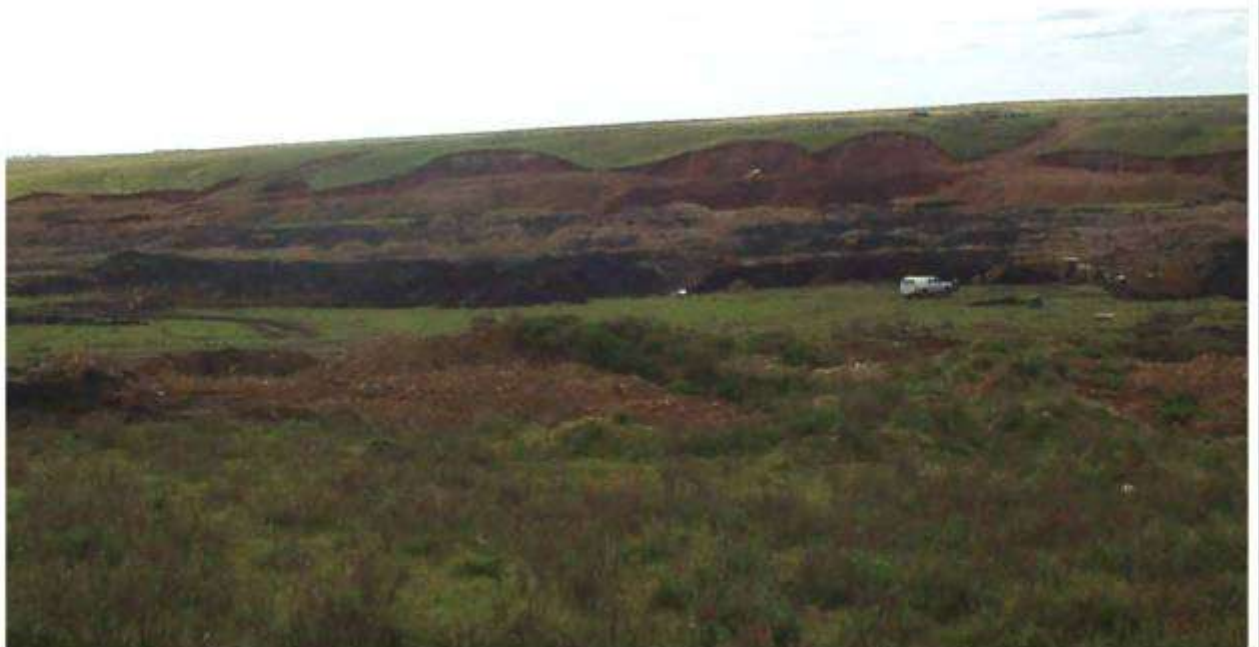
Figura 8.3-3 : Tipo de extracción en forma de cavas y mixta. Foto superior: cerca de 6 m de roca blanda que incluye basalto mineralizado in situ alterado, tapado por escombreras "ricas", que también son explotadas. La operativa incluye 3 retroexcavadoras que permiten trabajar en varios niveles y alcanzar gran profundidad. En primer plano, en el piso de la cantera aflora basalto tenaz (roca dura) de donde se extraen grandes geodas. En la foto inferior se observa en primer plano (donde se ubica la máquina) extracción en forma de cavas sobre material blando (Coluvión) y al fondo extracción en forma de frentes en roca blanda (basalto geoidal alterado in situ).
